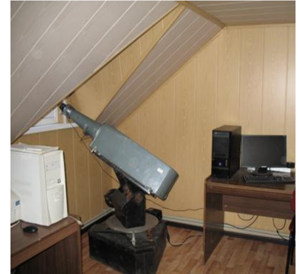
Рис. 1. Спектрограф СП-50, с помощью которого ведутся регулярные наблюдения эмиссий ночного излучения области мезопаузы на Звенигородской научной станции
